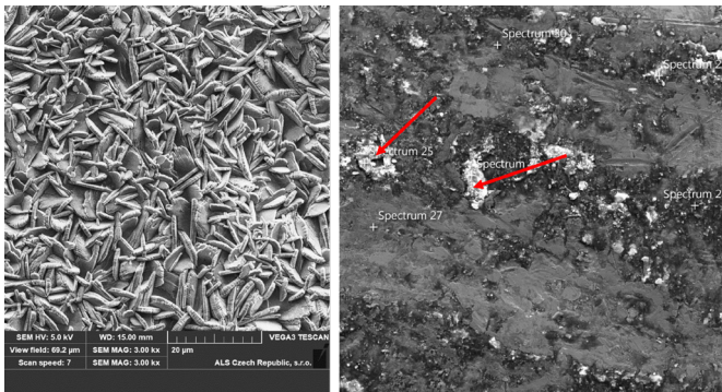
Figura 2: (A) strat anticoroziv; (B) urme de coroziune
